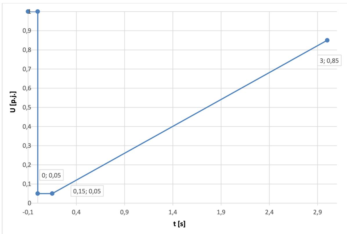
V prípade nesymetrickej poruchy platia rovnaké krvky ako v prípade poruchy symetrickej
